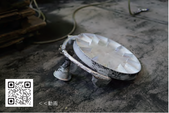
砂型鑄造：株式会社高田製作所
