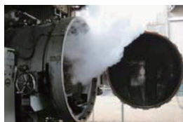
乾溜釜（竹片を炭化）
